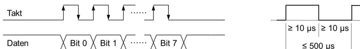
Die High- bzw. Lowperiode des Taktimpuls muss  $\geq 10 \mu\text{s}$  sein, die Gesamtperiode für ein Bit darf nur maximal  $500 \mu\text{s}$  betragen. Der Master liefert immer den Taktimpuls für die Datenübertragung. Das erste übertragene Bit ist das LSB (Bit 0).
